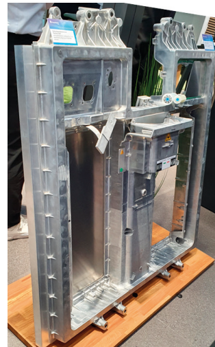
Figure 23 – Boîtier de batterie de démonstration du procédé Fusi@nCASTING
