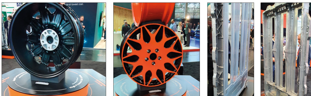
Figure 8 : Roule allégée et support batterie injectés sous pression présentés par HANDTMANN
