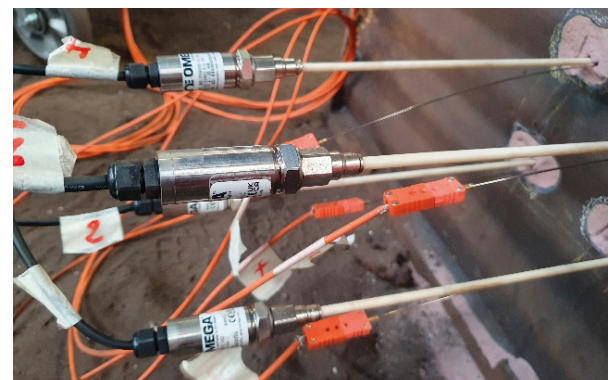
Figure 6 : Capteurs de pression hors châssis
