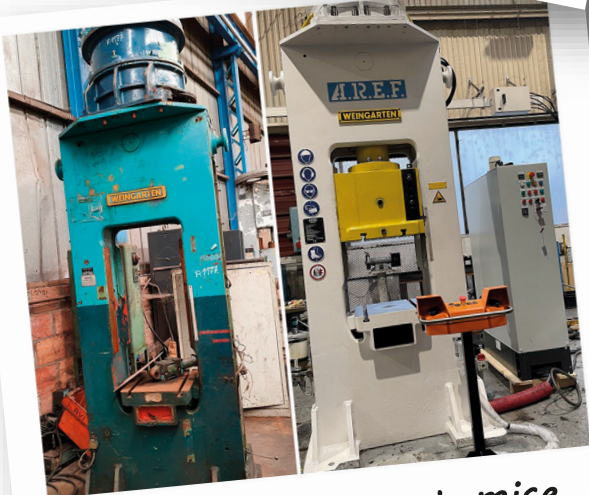
Reconstruction et mise en conformité
