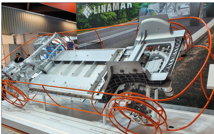
Figure 6 : composants de structures sur e-véhicule et carter de batterie présentés par LINAMAR
