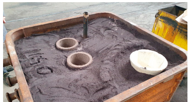
Figure 5 : Moule en sable (avant instrumentation)
