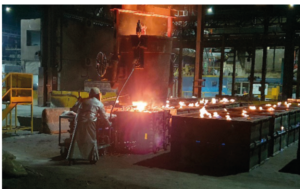
Figure 7 : Coulée par poche à quenouille (7 tonnes)
