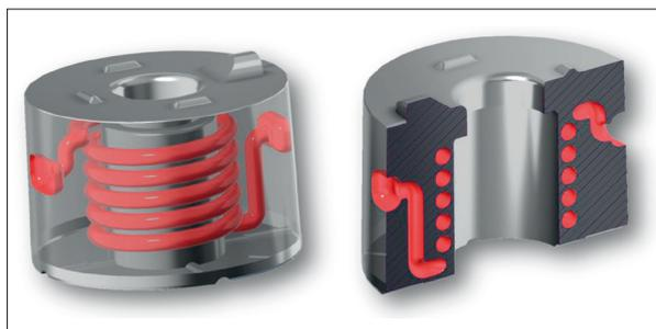
Figure 4 : Réalisation de canaux internes au sein d'un outillage de forge
