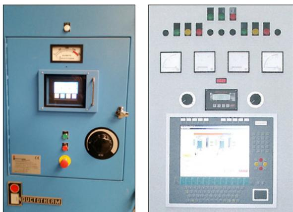
Figure 5 : Exemple de pupitres de commandes (gauche Inductotherm ; droite ABP Induction) qui indiquent la valeur d'isolement du creuset.
