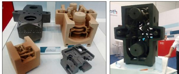
Fig.7 – Noyaux complexes & noyaux de grande taille en FA (BOSCH REXROTH)
