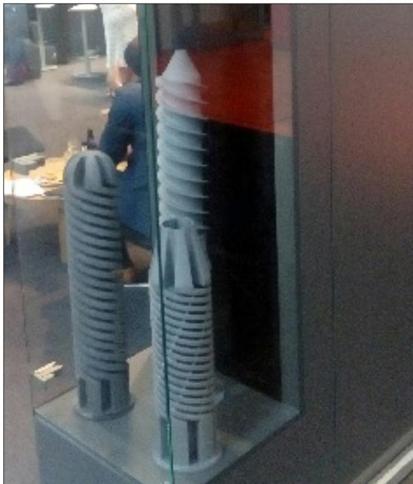
Fig.9 – brûleur céramique Amasic-3DTM (Saint Gobain AM)
