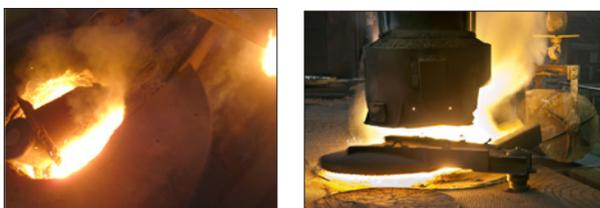
Figure 2 : Cas rares d'éléments de la charge arc-boutée. Fusion stoppée risque de surchauffe.
