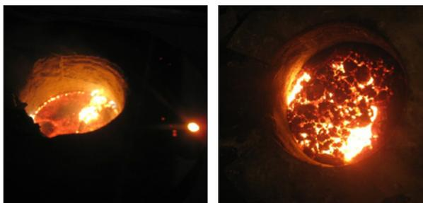
Figure 4 : Exemple de laitier à la surface du bain ; assez couvrant et fluide ou en amas grumeleux.
