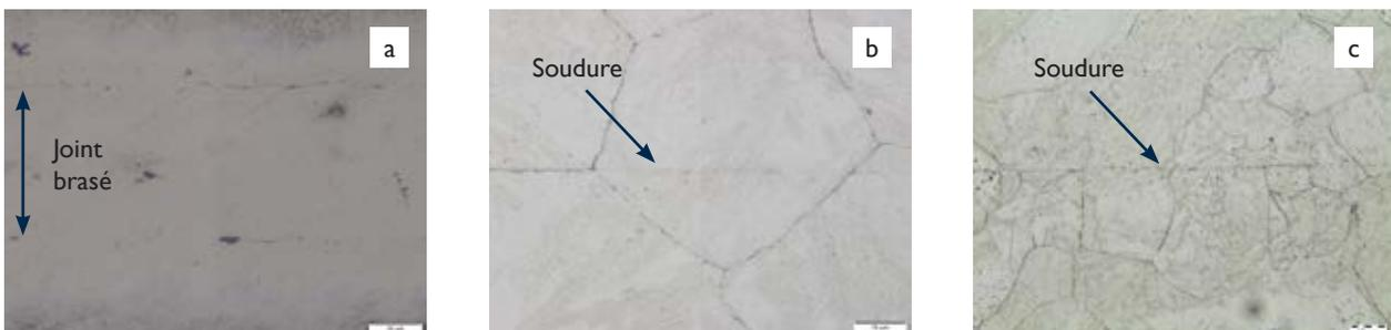
Figure 9 : Micrographies des joints brasé-diffusé (a), soudé-diffusé (b) et réalisés par CIC (c)
