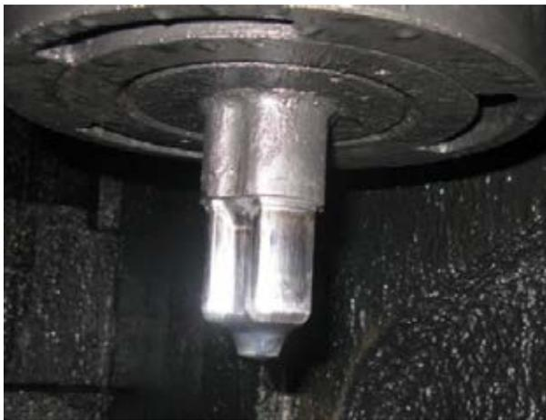
Figure 10 : Test du poinçon en Maraging 300
