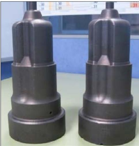
Figure 7 : Poinçons réalisés par fusion laser
