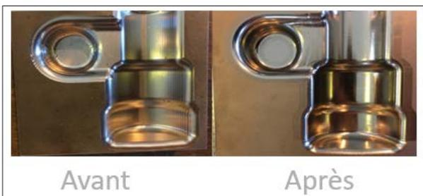
La rugosité obtenue après martelage est un Ra de 0.3 µm et Rz de 1.3 µm. Le Ra a été divisé par 4,7 et le Rz par 5,4.
