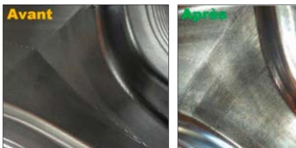
Une mesure de dureté a également été réalisée : autour de 55 Hrc.
